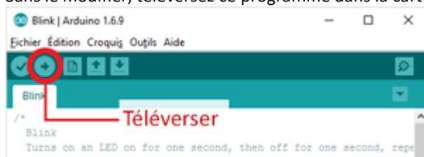
3. Résultat : la DEL intégrée doit clignoter à la fréquence d'un cycle allumage/extinction toutes les deux secondes.
